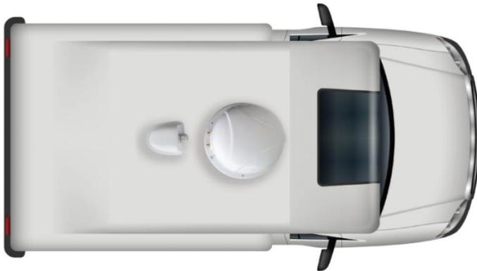
L'antenne doit être positionnée sur le toit du camping-car avec les 4 câbles orientés vers l'arrière du véhicule.
