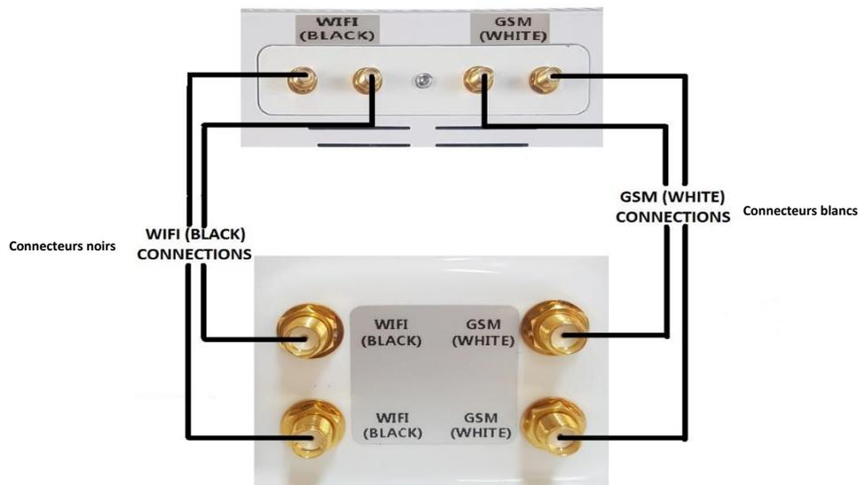
Branchement des câbles à l'antenne
