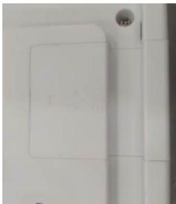
Insérez la carte Micro-SIM dans l'unité intérieure. Utiliser la forme sur le boîtier pour l'insérer dans le bon sens.
