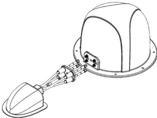
Schéma d'utilisation du passe-toit et de la fixation des câbles sur l'antenne.
