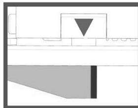
Die Pfeilanzeige darf sich nicht im roten Bereich befinden. Entfernen Sie den Adapter wieder.
