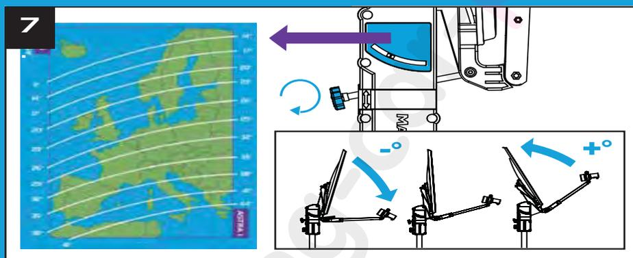
7. Utilisez la carte d'altitude pour déterminer l'angle requis pour votre emplacement. Réglez le plat à cet angle en utilisant le bouton d'élévation et l'indicateur
