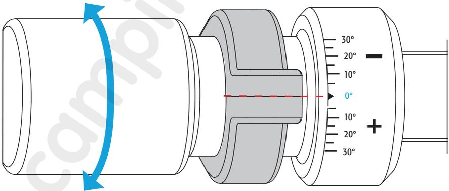
Aligner l'indication d'angle d'inclinaison avec la flèche ou la ligne de séparation (surlignée en rouge). Pour un angle correct, voir la page suivante pour Skew Map
