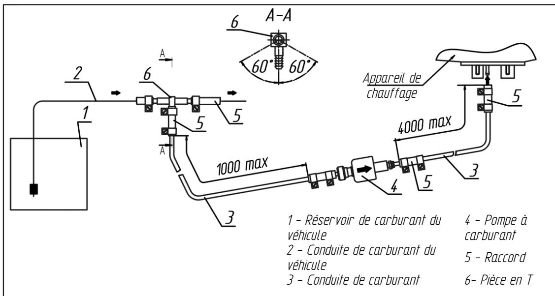
**Fig. 17 - Aspiration de carburant à l'aide d'une pièce en T**
