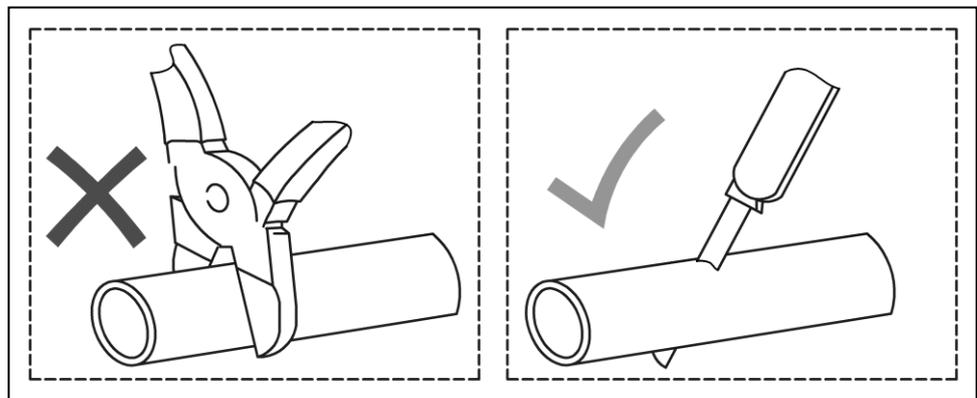
**Fig. 21 - Découpe de la ligne avant l'installation.**
