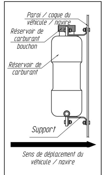
**Fig. 16 Installation du réservoir de carburant**
