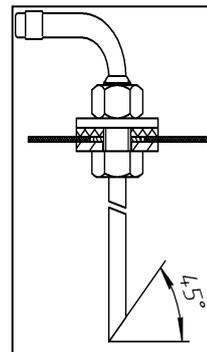
Fig. 15a - Installation du tuyau d'aspiration de carburant
