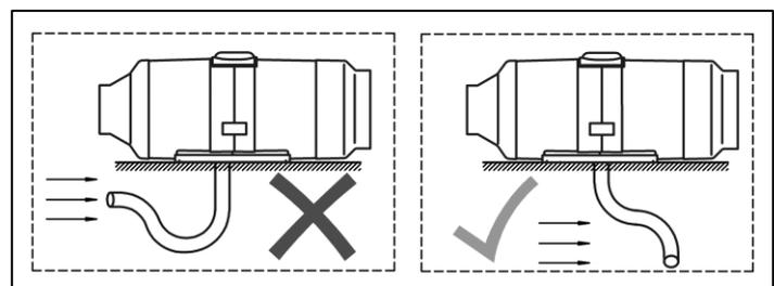
Fig. 5 - Position du tuyau d'admission d'air / d'échappement d'air
