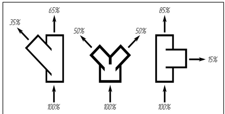
Fig. 25 - Exemples de distribution d'air avec différents composants
