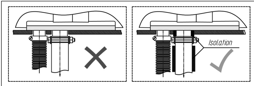
**Fig. 12 - Installation d'une isolation thermique supplémentaire**
