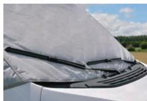
*L'isolant est plaqué sur le pare-brise avec les essuie-glaces*
