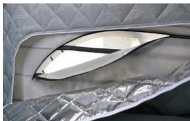
**Pratique ! Les ouvertures latérales montées sur fermeture à glissière** offrent un accès à la toile du toit relevable sans retirer l'isolant.
