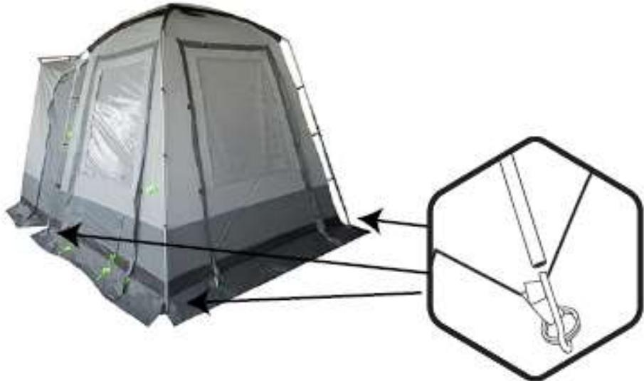
3. Heben Sie das Vorzelt an und klippen Sie die Abspannbänder in der richtigen Position an.
