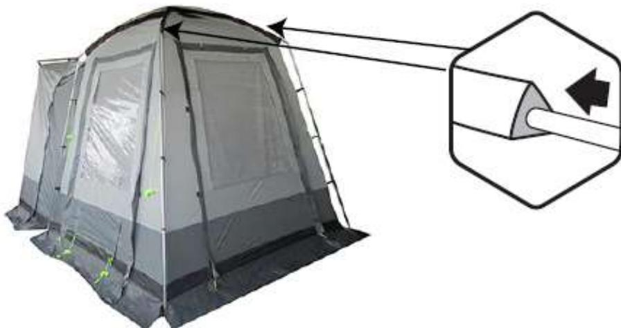
2. Mettere le quattro gambe in acciaio nella posizione sopra indicata, inserire le estremità del palo in fibra di vetro sul palo di acciaio,
