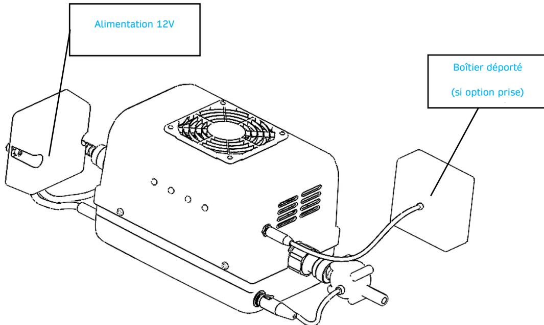
\* Pour un branchement sur 24V – couper le fil entre le transformateur et le produit et se raccorder directement
