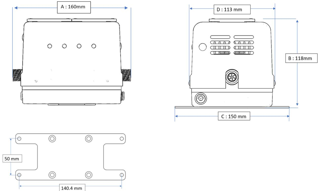
\*4 trous de fixation  $\varnothing 4,5\text{mm}$
