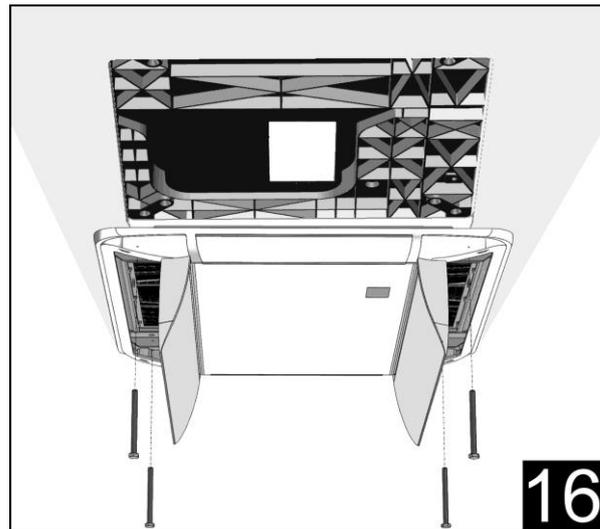
Ouvrez les deux portes d'accès aux vis de fixation et aux filtres à air qui se trouvent sur le diffuseur.
