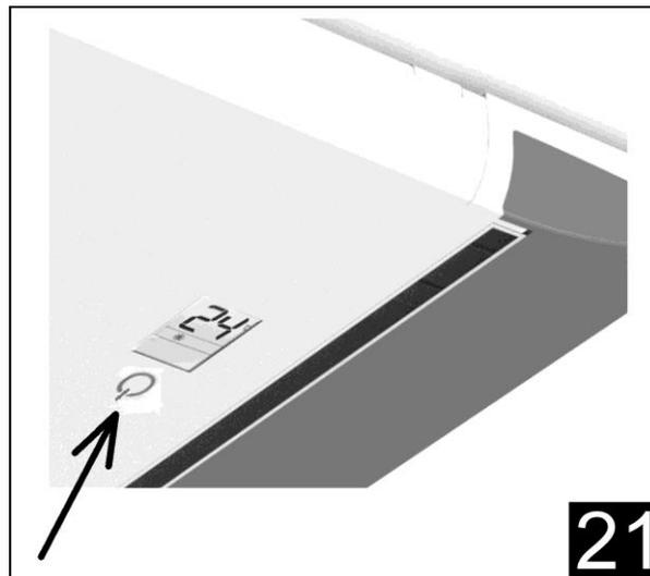
En cas de perte ou de problèmes de fonctionnement de la télécommande, vous pourrez dans tous les cas mettre en route et arrêter le climatiseur en touchant, pendant environ 5 secondes, la zone tactile (pictogramme de l'interrupteur ON-OFF en relief) située à côté de l'afficheur .
