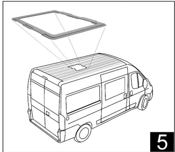
Assurez-vous que le raccord entre l'adaptateur et le toit du camping-car est parfaitement scellé au moyen du joint fourni avec l'adaptateur ou bien de mastic.
