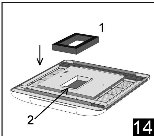
Mettez le diffuseur à l'horizontale et placez le raccord rectangulaire en caoutchouc expansé
