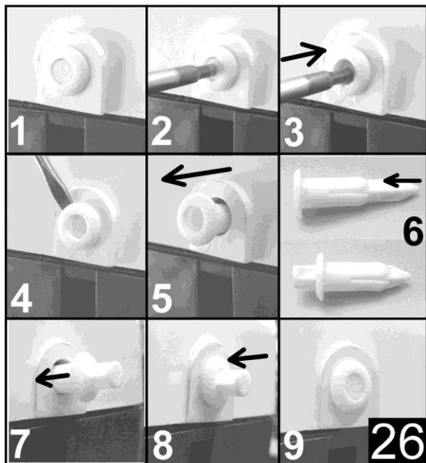
Le couvercle extérieur en ABS est fixé au fond par 6 rivets qui peuvent être remis en position. Pour les extraire, procédez de la manière indiquée dans la figure 26.
