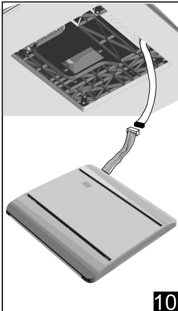
Branchez le connecteur du câble plat de l'afficheur du diffuseur au connecteur du câble plat correspondant du circuit imprimé électronique du climatiseur (figure 10).
