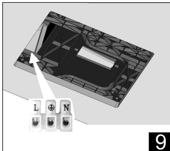
Contrôlez que le câble d'alimentation n'est pas trop long car, si c'est le cas, il obstruera les bouches d'aspiration.
