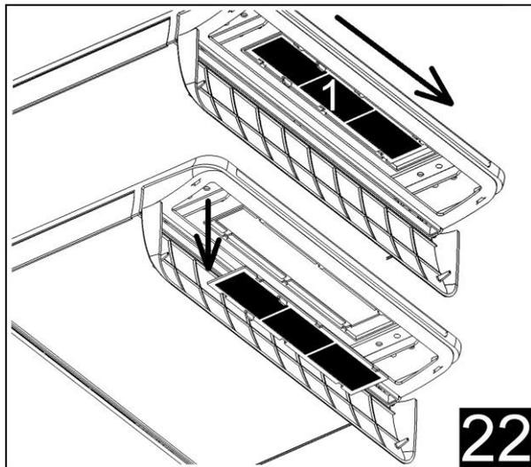
Pour sortir les filtres (figure 22, repère 1), ouvrez chaque porte du diffuseur puis faites-les glisser en respectant les flèches de direction de manière à ce qu'ils se décrochent. Une fois l'entretien terminé, remettez les filtres en place et fixez-les en les faisant glisser dans l'autre sens.
