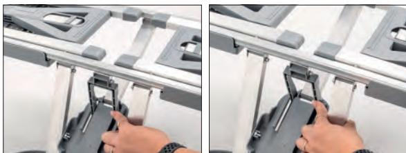
**DE - Schritt 3:** Befestigen Sie die Tragarme mit dem Verriegelungsschieber.
