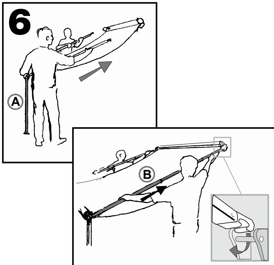
**DE** Den Stützfuß A festhalten, dabei den Rafter B anheben und ausziehen, bis das Rafterende in die Kunststoffauflage (Spannarmauflage) fest aufliegt.
