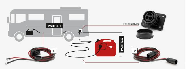
Partie 1 > Montage sur cloison intérieure: Câble de charge jumelé équipé d'une fiche femelle pour fixation murale et 2 cosses à l'extrémité pour raccordement à la batterie (1).
