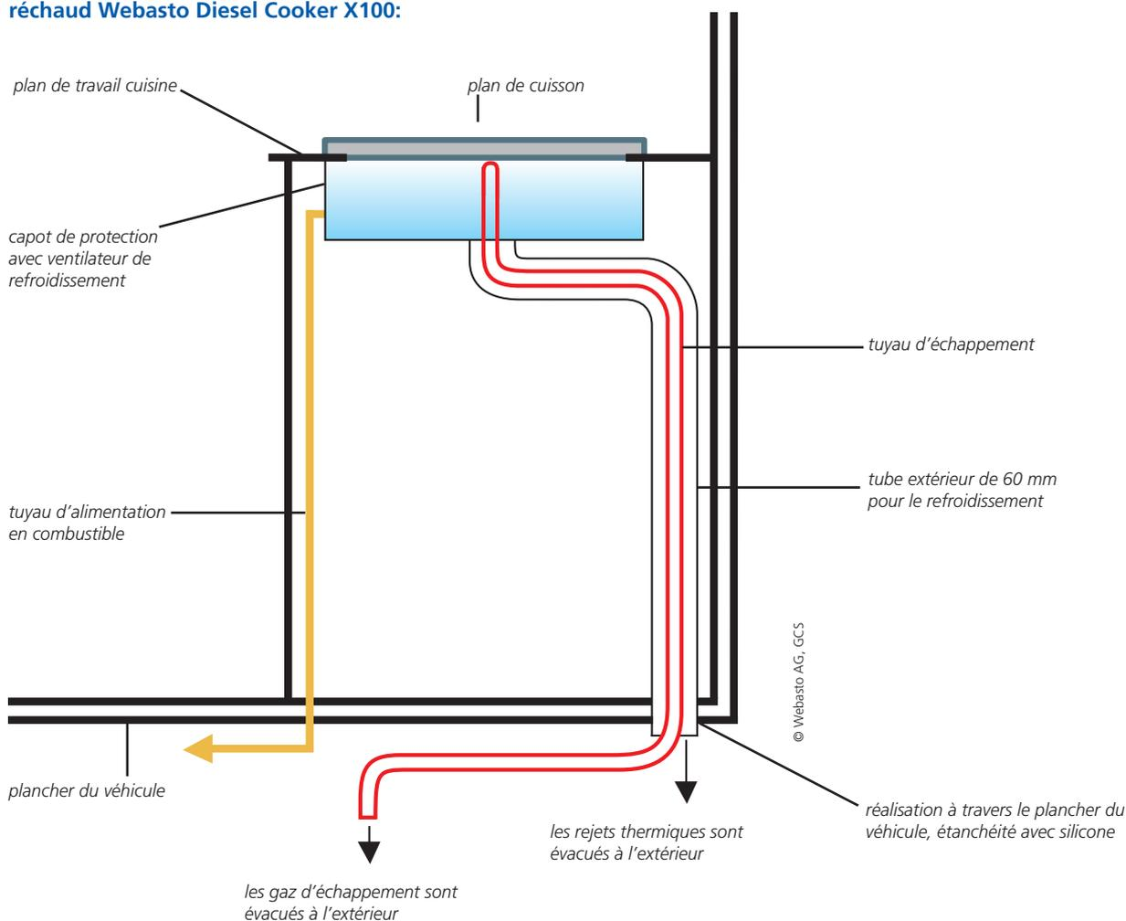
Le montage du réchaud est réalisable sans difficulté dans la plupart des véhicules. Le réchaud est placé par en haut dans le logement du plan de travail de cuisine. Depuis le bas, on monte un capot de protection; il comporte un ventilateur de refroidissement intégré qui veille à ce que les rejets thermiques soient évacués à l'extérieur au moyen d'un tube coaxial flexible, depuis le dessous du réchaud.
