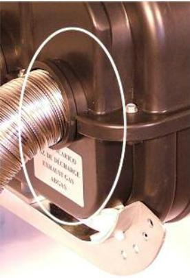
Plier le tuyau ("en siphon") (voir photo). Percer le point le plus bas par un foret Ø 3,5 à 4 mm.
