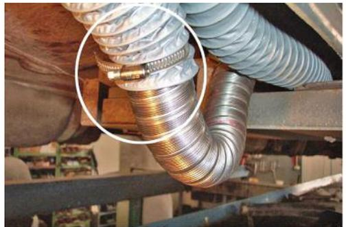
Si on canalise les gaz au sol, la partie terminale du tuyau peut être en acier flexible ou en PVC code 30280 (conseillé – voir photo).
