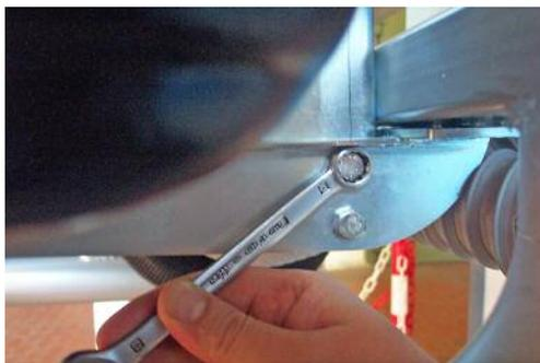
Fixer définitivement le cadre (code 30143) aux montants, par les boulons et les rondelles type Grower y relatifs. **Serrer à fond les boulons** qui bloquent les montants au châssis du camping-car, en interposant correctement les rondelles Grower fournies.
