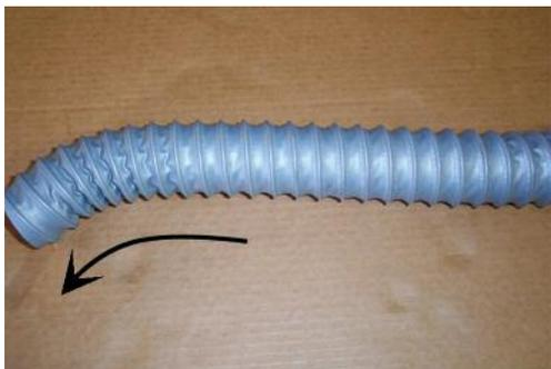
La partie terminale du tuyau d'échappement doit être légèrement tournée vers le bas, de façon à ne pas permettre la pénétration d'eau (pluie, lavage du véhicule, etc.).
