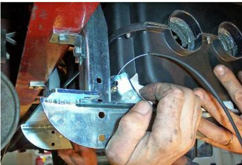
Soulever le support avec Eco Energy TG 480/600 et le mettre à sa position correcte.
