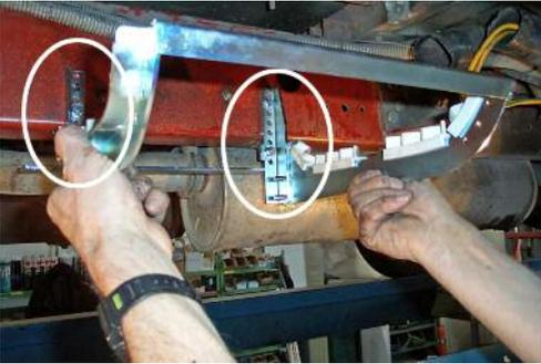
Marquer sur le longeron les trous (\*) de fixation à utiliser. Si possible, utiliser les trous déjà existants.
