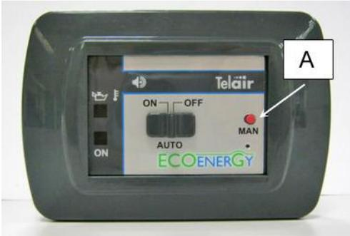
Une fois en marche, Eco Energy TG 480/600 reste en marche jusqu'à ce que la tension de batterie atteigne le seuil maxi programmé (14,5 Volt env.). **La durée du fonctionnement dépend de l'état de la batterie : de quelques secondes à quelques heures.**
