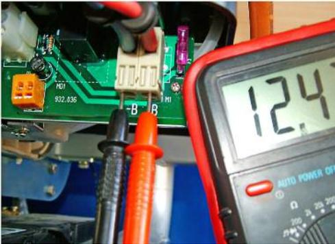
Dès que le niveau de tension de la batterie descend au-dessous du seuil mini (12 Volts env.)<sup>1</sup>, Eco Energy démarre automatiquement en reportant la batterie au seuil limite supérieur (14,5 Volts env.)<sup>1</sup>.
