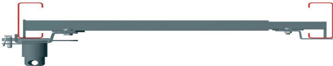
Pousser alors toute la fixation de suspension aussi loin sur les longerons que possible pour augmenter au maximum le poids qui repose sur le Camper Trolley, mais en s'assurant cependant que le montage et le démontage du Camper Trolley se fait sans difficulté.
