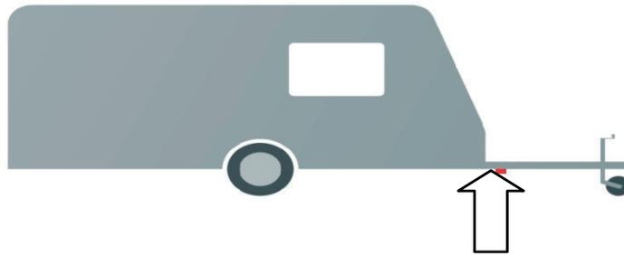
Les tubes de stabilisation sont repoussés aussi loin que possible l'un de l'autre vers les côtés des longerons, et les fixations droite et gauche sont fixées de manière à ce que le côté inférieur replié des fixations soit placé exactement contre le côté extérieur des longerons. S'assurer que la force de serrage appliquée sur les boulons soit maximale.
