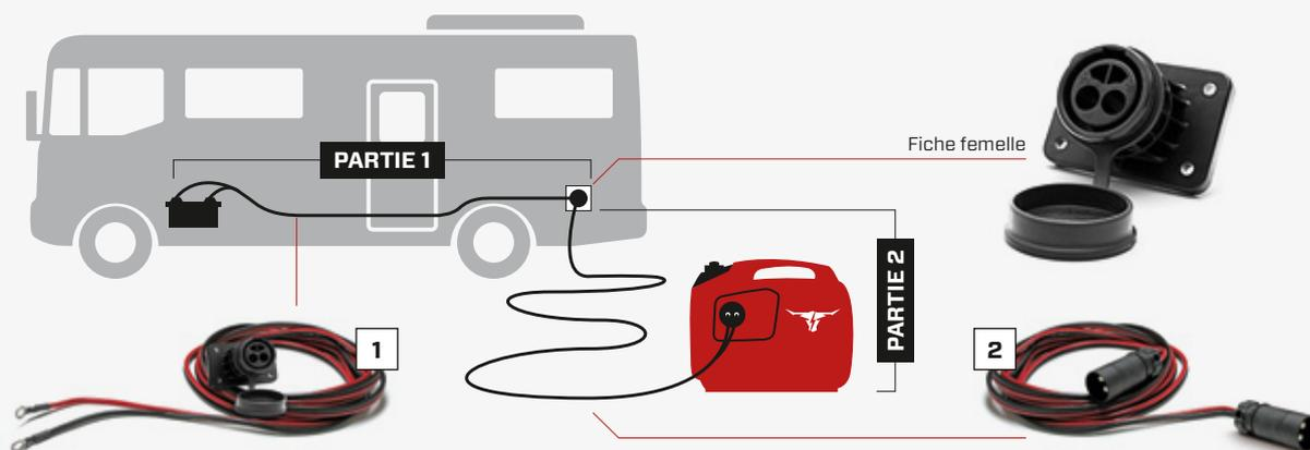
**Partie 1 > Montage sur cloison intérieure:** Câble de charge jumelé équipé d'une fiche femelle
